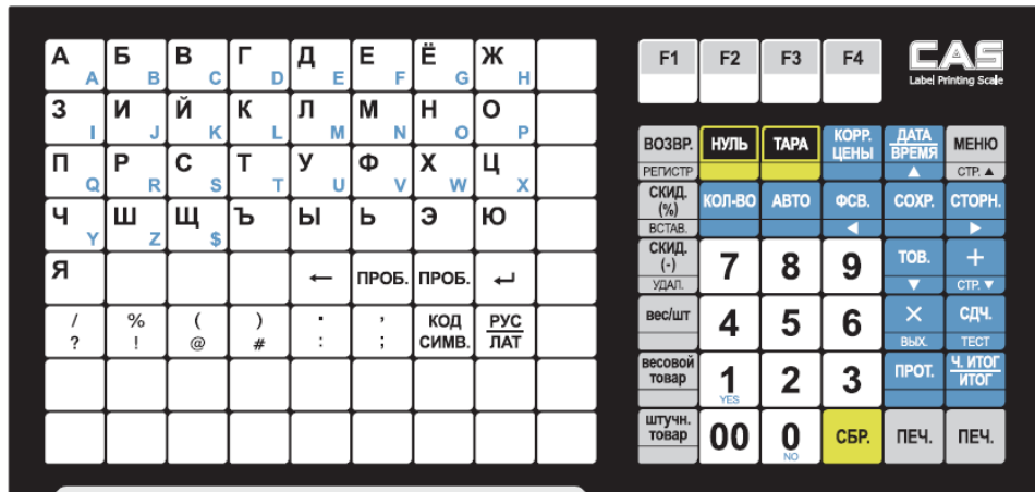
Рисунок 1.7 – Вид клавиатуры весов модификации CL5000-D
