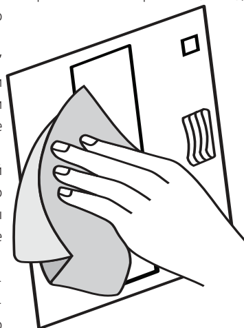
Рис. 3 Очистка пылесборных пластин
